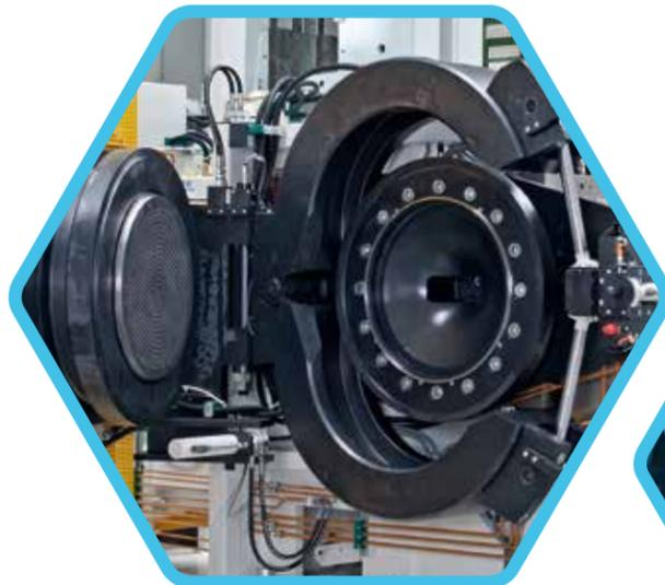
roll-ex® 过滤机头, 配有液压快速夹装置
